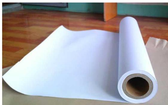
新闻纸又称白报纸，主要是供应报纸印刷使用，也有一些期刊选用白报纸的。适用于报纸、期刊、课本、连环画等正文用纸。新闻纸的特点有：纸质松轻、有较好的弹性；吸墨性能好，这就保证了油墨能较好地固着在纸面上。纸张经过压光后两面平滑，不起毛，从而使两面印迹比较清晰而饱满；有一
