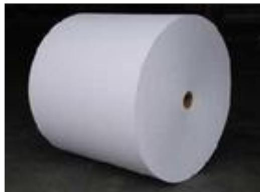
是填料含量较高，一般在 25%左右，最高可达 35%。由于经过超级压光整饰，因而有相当高的平滑度。纸张质量主要取决于纤维原料和填料的质量，以及它们在纸页两面的分布。根据其质量情况，SC 纸可分为 SC-A+，SC-A，SC-B，SC-C 几种。
